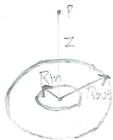
$R_{in}=0.2R_{out}$  και ομοιόμορφη επιφανειακή πυκνότητα φορτίου  $\sigma=6.2\text{ pC/m}^2$ . Να βρείτε το ηλεκτρικό δυναμικό στο σημείο  $P$  πάνω στον κεντρικό άξονα του δίσκου, σε απόσταση  $z=2R_{out}$  από το κέντρο του. (Δίνεται ότι το ηλεκτρικό δυναμικό ομοιόμορφα φορτισμένου δακτυλίου, ακτίνας  $a$ , φορτίου  $Q$ , σε σημείο στον κεντρικό άξονα, σε απόσταση  $x$  από το κέντρο του δακτυλίου είναι:
