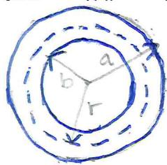
διαρρέει, ομοιόφορμα κατανεμημένο, ρεύμα,  $I$ . **α)** Βρείτε το μέτρο  $B(r)$  του μαγνητικού πεδίου, για ακτινική απόσταση  $r$  στο εύρος  $b < r < a$ . (**2**). **β)** Υποθέστε ότι  $a=2\text{ cm}$ ,  $b=1.8\text{ cm}$ , και  $I=100A$ . Σχεδιάστε το  $B(r)$  ως συνάρτηση του  $r$  (**0.5**).
