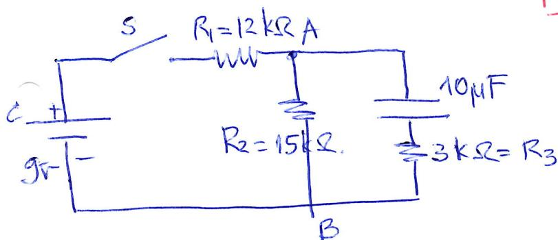
Tια την  $R_1+R_2$ : Αναρτάται ονδημένοι συν σερά, αφού  $R_{tot} = R_1+R_2 = 27 \text{ k}\Omega$ ,
