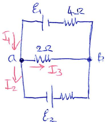
$$\text{Άρα: } V_B - V_A (\equiv \Delta V) = -I_3 \cdot (2\Omega) = -1.82 \text{ V.}$$
