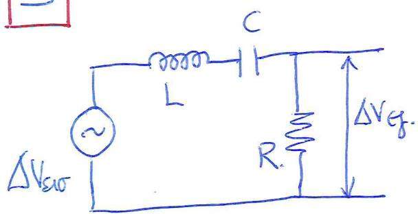
Ο αριθμός των εικόνας αναποιχεί στο μεγάφυτο μεσίτη συντούτων των ήχου τριών μεγαφών. Θεωρήστε ότι η αντίσταση του ειναι σταθερή και ιση με  $8\Omega$ . Η πηγή αναποιχεί σ' ένα ενισχυτή ήχου που παρέχει σημάδια σταθερού ηλάτου,  $\Delta V_{max} = 10V$  σ' όλες τις συντούτες. Ο συνδυασμός πηνιου και πουνωτή λειτουργεί ως φίλαφο διέλευσης ήχου (γαλοφάτο φίλαφο) με  $\frac{\Delta V_{max,erg}}{\Delta V_{max,eis}} = \frac{1}{2}$  στα  $200\text{ Hz}$  και στα  $4 \times 10^3\text{ Hz}$ .
